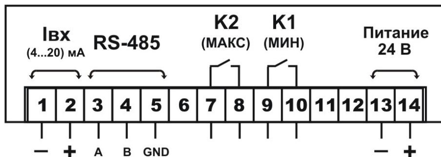
Рисунок Г.5 – Расположение выводов клеммной колодки прибора ЦИ5003Б/2 (исполнение с интерфейсом RS-485).
