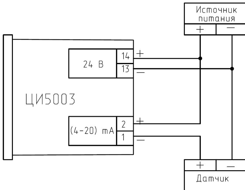
Рисунок Г.2 - Схема внешних соединений прибора ЦИ5003Б и датчика с двухпроводной линией связи при объединенном питании.
