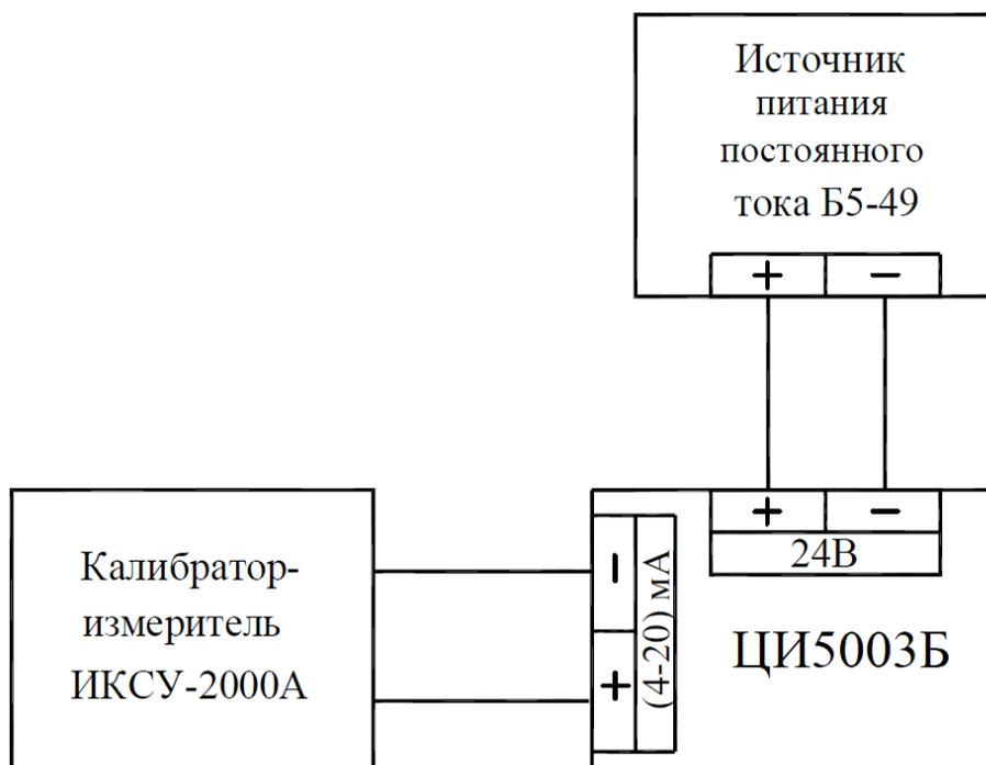
Рисунок Д.1 – Схема подключения приборов ЦИ5003Б
